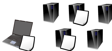
図 2: GlusterFS はファイルの複製をサーバーに分散する。
